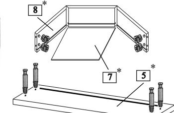
В накладку ящика вворачивается дюбель эксцентриковой стяжки. Ящик складывается согласно схеме, в паз вставляется дно, накладка стягивается с корпусом ящика. **Предварительно просверлив отверстия Ø 2,5 мм**, крепятся направляющие шурупами 4x13. Шурупом 4x16 через фиксатор приворачиваем дно ящика (рис. №6)
