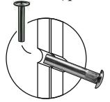
После установки всех секций наместо и их выравнивания сверлятся отверстия Ø 5мм.
