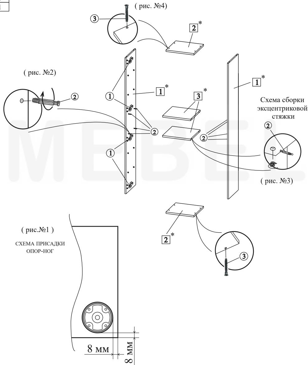
После установки всех секций наместо и их выравнивания сверлятся отверстия Ø5мм.
