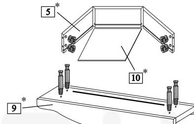
В накладку ящика вворачивается дюбель эксцентриковой стяжки. Ящик складывается согласно схеме, в паз вставляется дно, накладка стягивается с корпусом ящика. **Предварительно просверлив отверстия Ø 2,5 мм,** крепятся направляющие шурупами 4x13. Шурупом 4x16 через фиксатор приворачиваем дно ящика (рис. №7)
