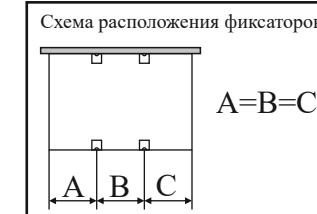
В накладку ящика вворачивается дюбель эксцентриковой стяжки. Ящик складывается согласно схеме, в паз вставляется дно, накладка стягивается с корпусом ящика. Предварительно просверлив отверстия Ø 2,5 мм, крепятся направляющие шурупами 4x13. Шурупом 4x16 через фиксатор приворачиваем дно ящика (рис. №5)
