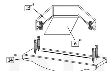
В накладку ящика вворачивается дюбель эксцентриковой стяжки. Ящик складывается согласно схеме, в паз вставляется дно, накладка стягивается с корпусом ящика. **Предварительно просверлив отверстия Ø 2,5 мм**, крепятся направляющие шурупами 4x13. Шурупом 4x16 через фиксатор приворачивается дно ящика (рис. №7).
