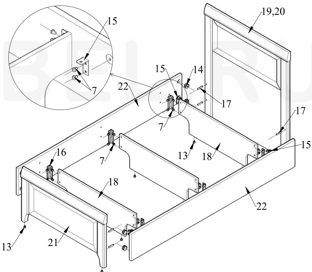
Порядковые номера метизов и деталей соответствуют комплектовочной ведомости №2 и комплекту фурнитуры.
