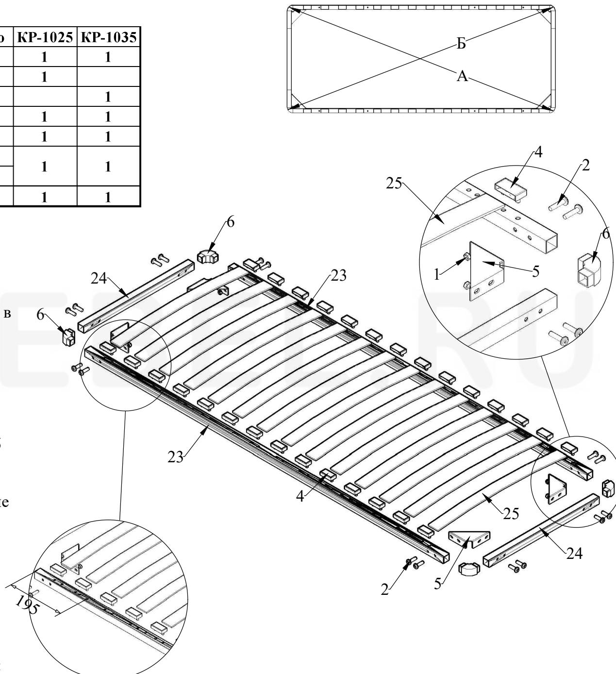
Порядковые номера метизов и деталей соответствуют комплектовочной ведомости №2 и комплекту фурнитуры.
