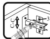
Если створка наклонена вправо или влево относительно вертикали корпуса, нужно выпрямить наклон створки в направлении А-А винтом 2.
