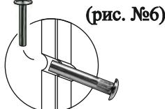
После установки всех секций наместо и их выравнивания сверлятся отверстия Ø8мм. и корпуса стягиваются между собой межсекционной стяжкой.
